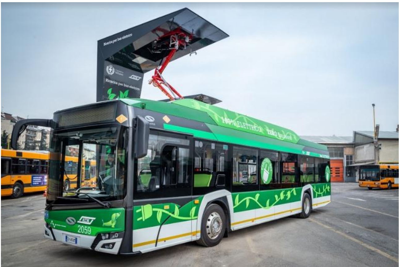
Figura 264. Ricarica tramite pantografo nel deposito di ATM a Milano
